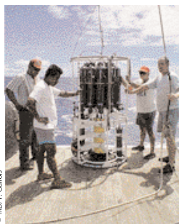
Cette bathysonde a été immergée plus de 80 fois à intervalles réguliers, tous les 50 à 100 km de la surface à 500 m de profondeur, au cours de la campagne Frontalis. Elle comprend des capteurs de température, salinité, pression, des bouteilles de prélèvement et un profileur de courant à effet Doppler.
