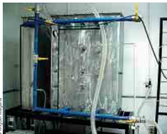
Biofiltre utilisé pour dépolluer les vapeurs d'essence.
