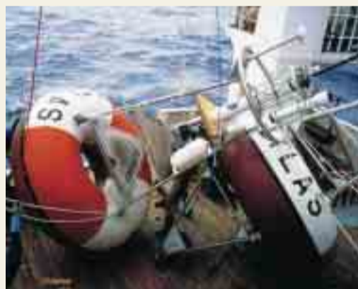
Septembre 1997, Golfe de Guinée, lors d'une campagne PIRATA, mouillages de deux bouées ATLAS. Elles mesurent des paramètres océanographiques et météorologiques et transmettent les données par satellite. PIRATA (Pilot Research moored Array in the Tropical Atlantic) est une composante du programme international CLIVAR sur la variabilité climatique.
