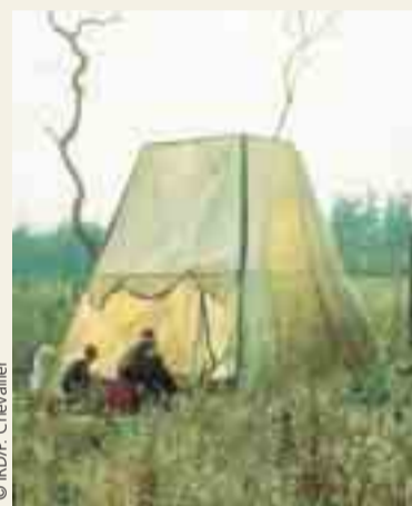
Simulateur de pluie et microparcelles préparées pour des tests sous simulation de pluie, équipée afin de suivre l'évolution de l'infiltration puis la dessiccation.
