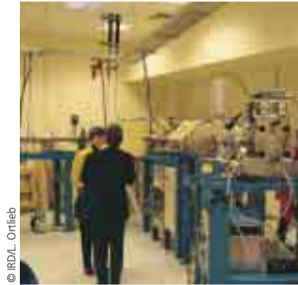
Accélérateur de particules Artemis dans le laboratoire de mesure du carbone 14.
