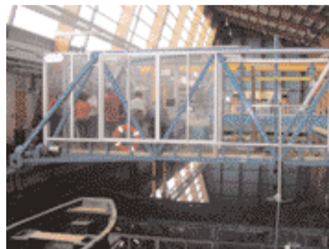
Étalonnage de sondeurs sur la passerelle du bassin d'essais du Centre Ifremer de Brest.
