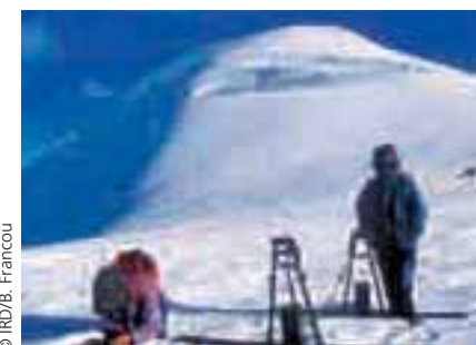
Mesures au géo-radar pour déterminer le meilleur site de forage, au sommet de l'illimani en Bolivie.
