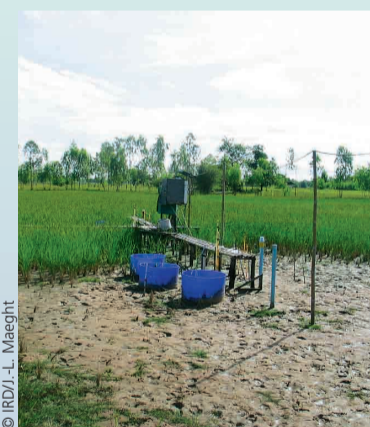
Dispositif de mesure des transferts hydrosalins dans une tache salée d'une rizière de Ban Daeng (région de Khon Kaen, nord-est Thaïlande) lors de la saison de culture 2005.
