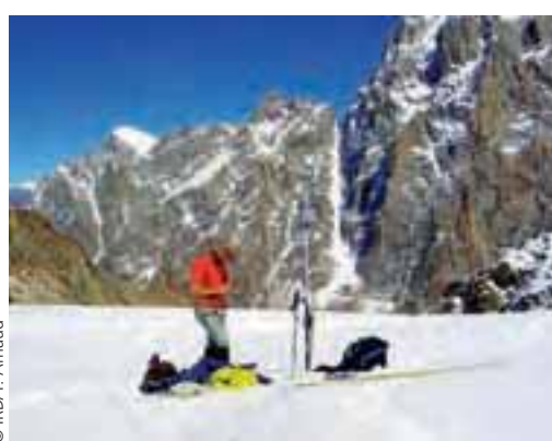
Relevé de la position d'une balise d'ablation au DGPS sur la langue du glacier Chhota Shigri à 4 400 m.
