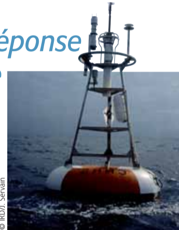
Les bouées du réseau d'observations in situ Pirata, grâce à la transmission des données par satellite, permettent de suivre quotidiennement l'évolution des paramètres océanographiques et météorologiques de l'Atlantique tropical.
