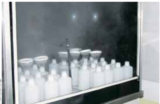
Brouillard permanent dans l'enceinte de nébulisation.
