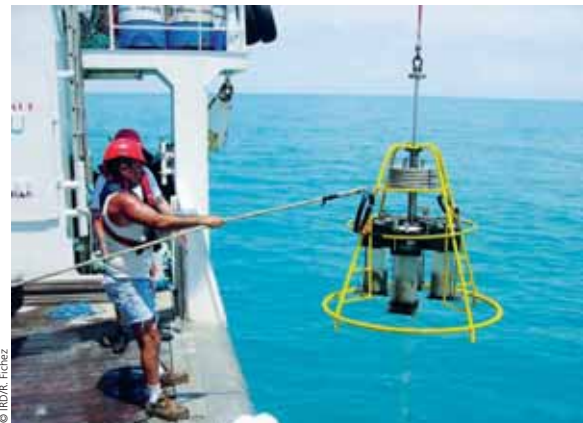
Récupération de carottes de sédiments pour mesure des flux entre le sédiment et l'eau, Sonda de Campeche, Mexique.
