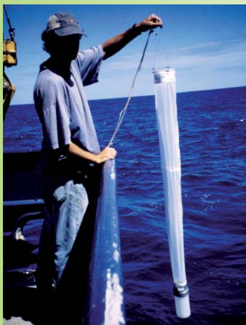
Remontée d'un filet à plancton permettant d'échantillonner les organismes à différentes profondeurs.
