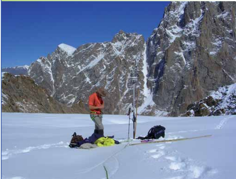
Relevé de la position d'une balise d'ablation au DGPS sur la langue du glacier Chhota Shigri à 4400m
