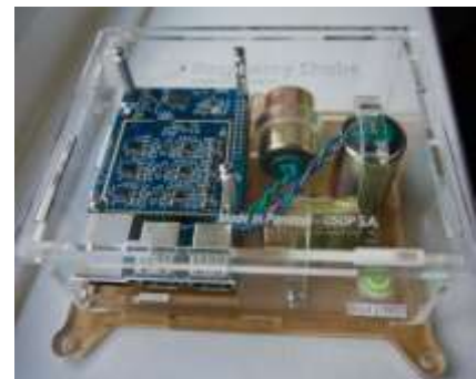
© Steve Hicks : sismomètre citoyen installé par un co-auteur de l'étude. Cet appareil permet de mesurer les mouvements forts du sous-sol et de partager les données récoltées.
